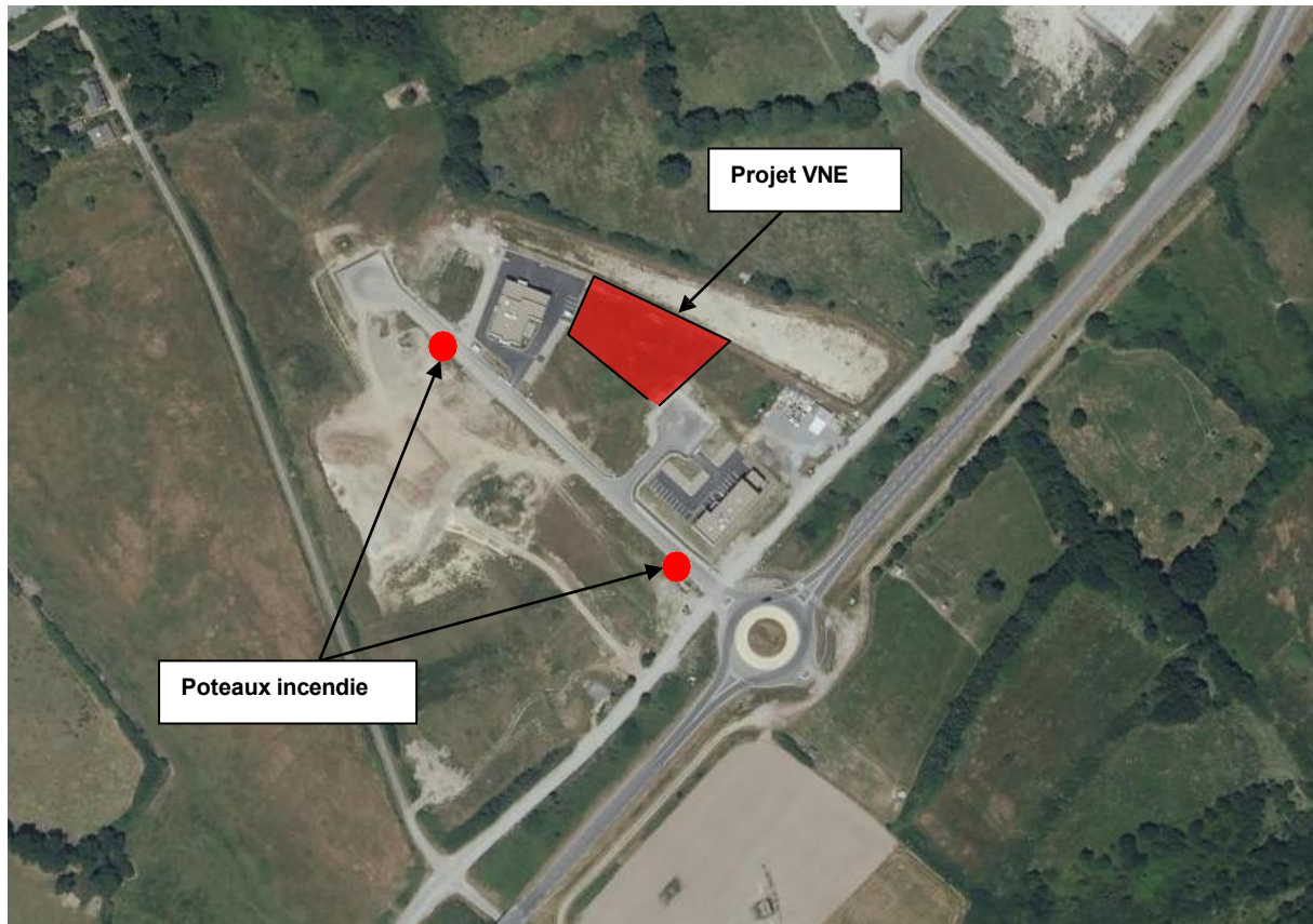
Figure 2 : Implantation des poteaux incendie
