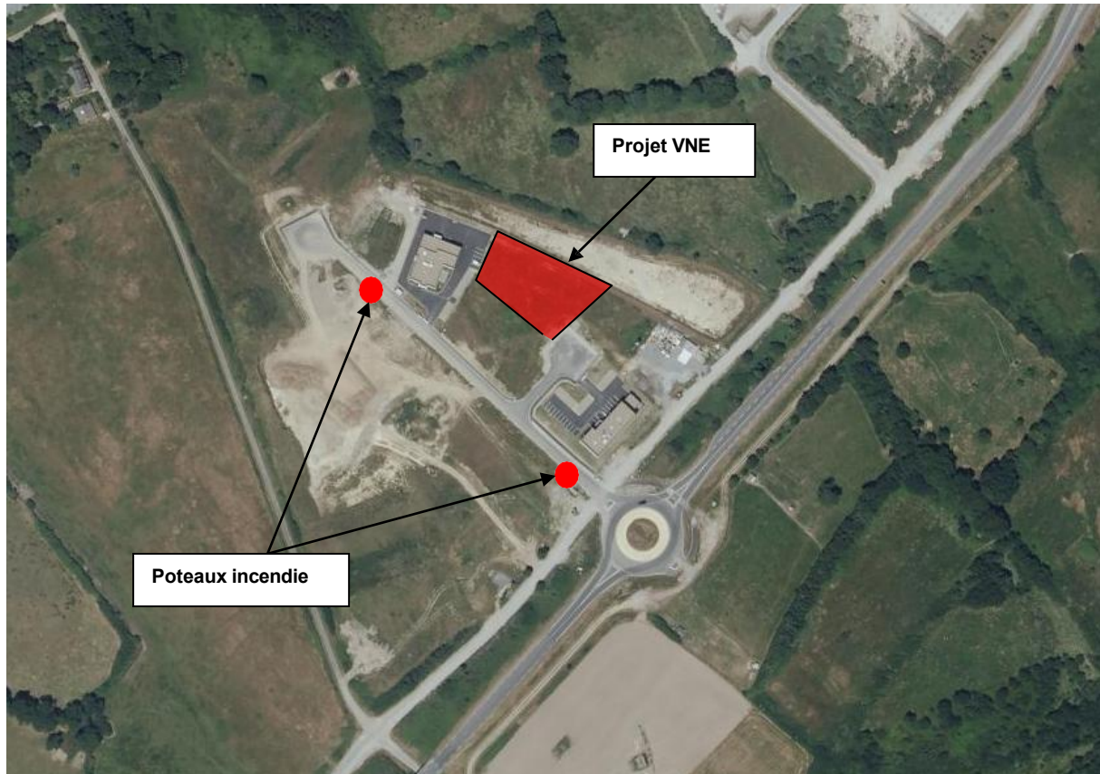
Figure 12 : Implantation des poteaux incendie
