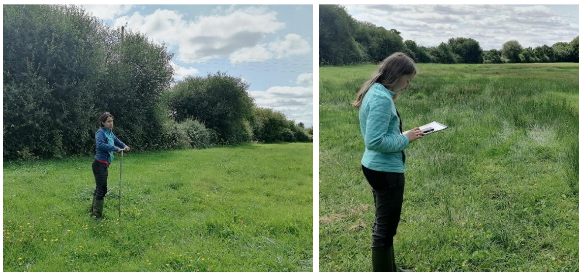
Figure 6 : Prospection dans le cadre de la réalisation d'un inventaire de zone humide intercommunal : sondage pédologique, caractérisation et usage de la saisie sur tablette (DCI Environnement)
