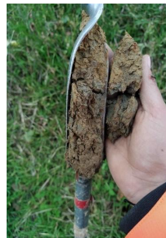
Figure 5 : Sondage pédologique présentant des caractéristiques de ZH (© DCI environnement)
