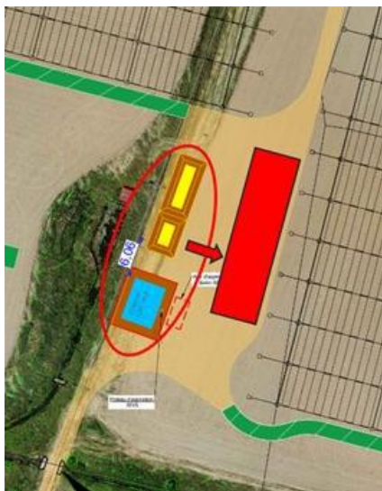
Déplacements du poste de transformation et de la citerne au centre du projet (encart gauche) ainsi que du poste de transformation au sud-ouest du projet d'ombrières agrivoltaïques de Lherm pour les éloigner des fossés (encart droit)
