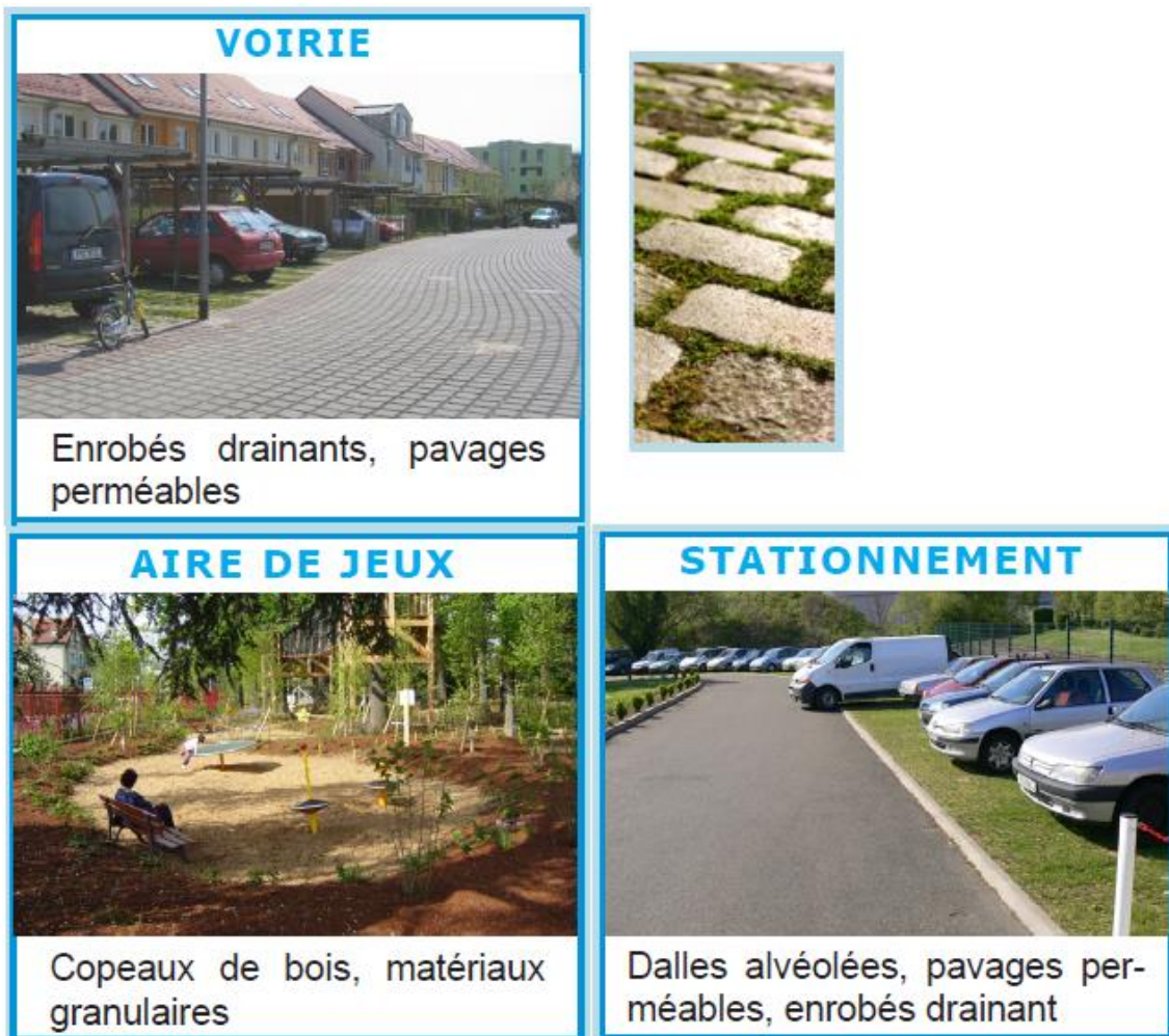
Figure 19 : Photos d'exemples d'alternatives à l'imperméabilisation du sol
