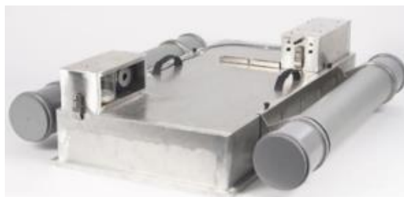
« Chambre à flux » ou « hotte ventilée » utilisée par Odournet France
