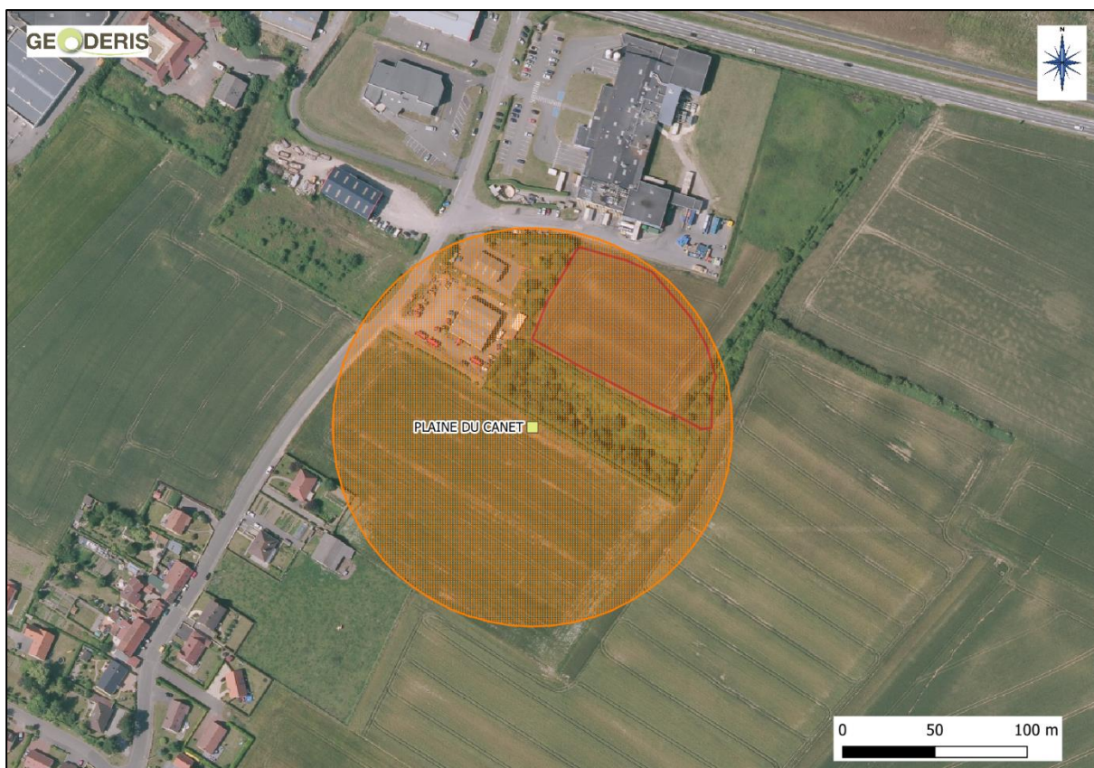
Figure 2 – Aléa « effondrement localisé » de niveau moyen associé au puits Plaine du Canet (en rouge, l'emprise de la zone investiguée)
