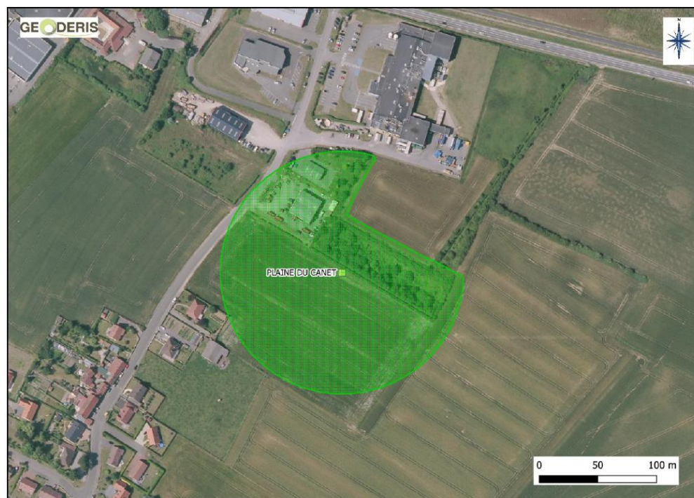
Figure 6 : Carte actualisée de l'aléa "effondrement localisé" de niveau limité associé au puit Plaine du Cabet (source : GEODERIS)
