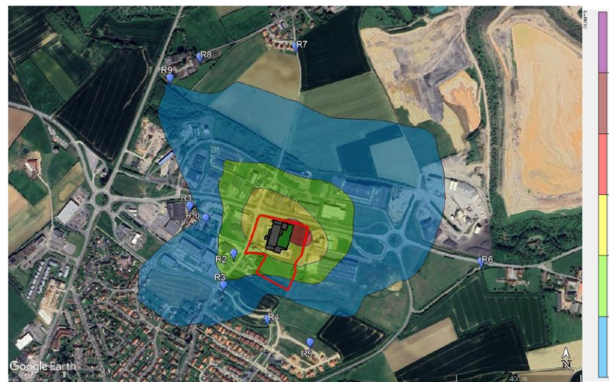
Figure 9 : Cartographie zoomée de l'impact global en odeurs du site au Percentile 98, état futur (source : ODOURNET)
