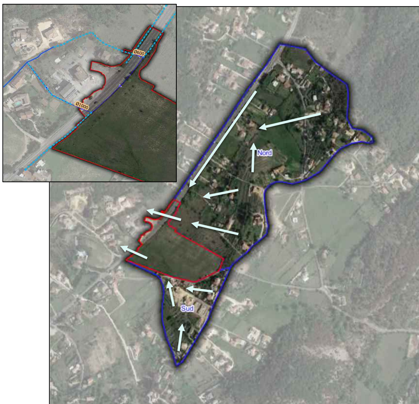
Illustration 7 : Fonctionnement hydraulique actuel
