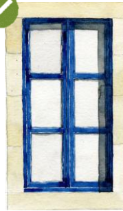
Fenêtre à 2 vantaux et 6 carreaux, en bois peint. © UDAP 29
