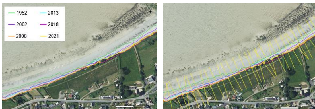
Figure 9 : exemple de tracés historiques et tracé de transects - Plage de Nantouar (fonds IGN).
