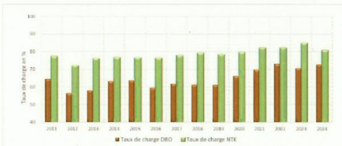
Evolution du taux de charge DBO5 et du taux de charge NTK depuis 2011
