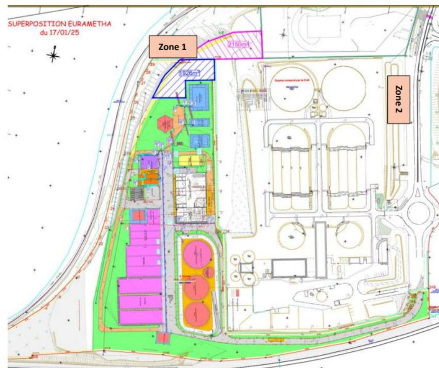
Figure 8 : Localisation du foncier disponible pour la mise en place d'un traitement tertiaire (Source CUA, 2025)
