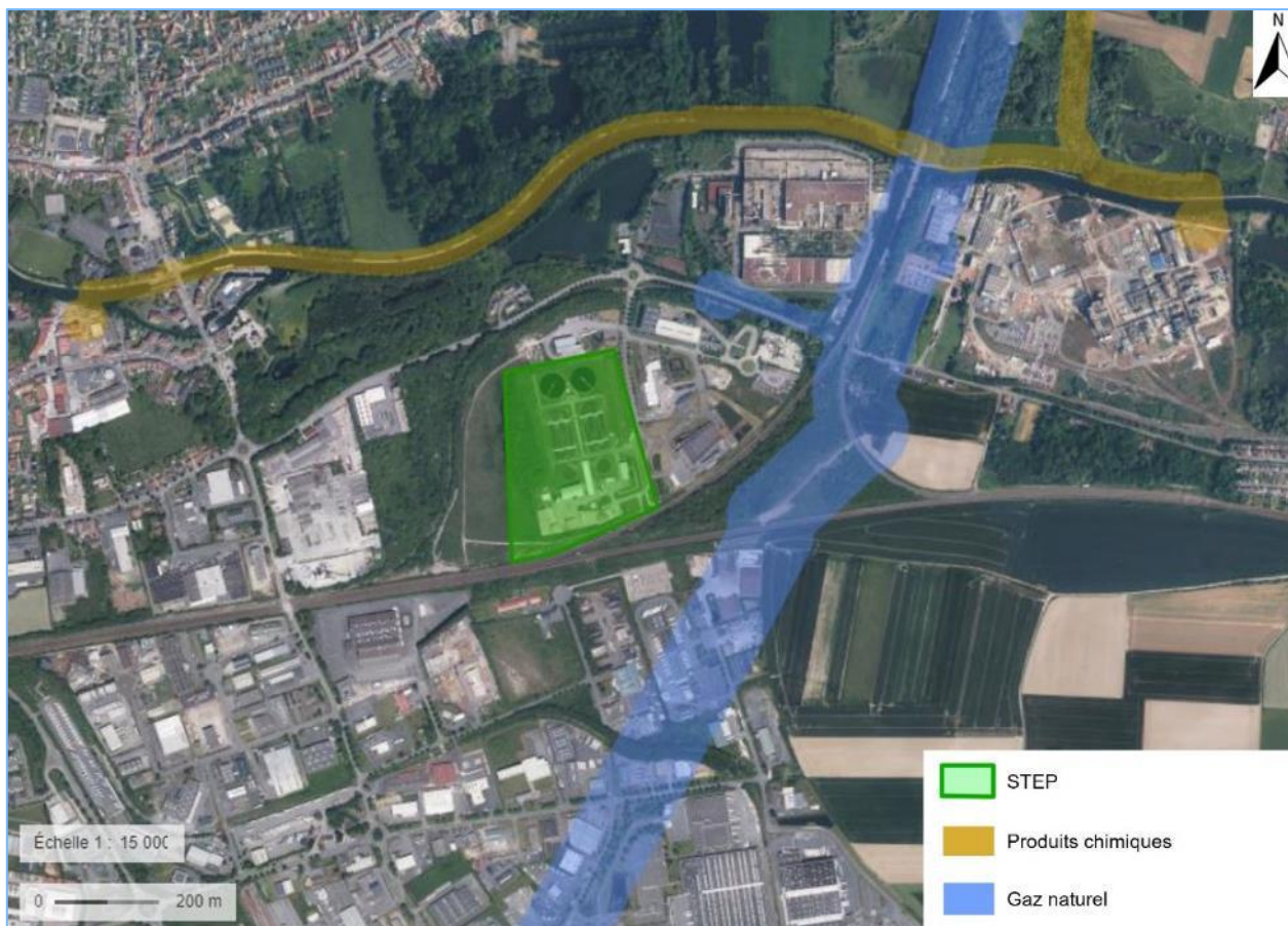
Figure 104 : Carte des canalisations de transport de matières dangereuses près de la STEP de Saint-Laurent-Blangy (Source : Géoportail, 2022)
