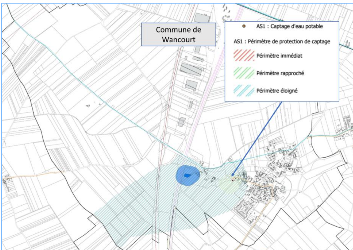
Figure 68 : Localisation des périmètres de protection autour du captage d'eau potable sur la commune de Wancourt (Source : PLUi 39 communes – plan des servitudes d'utilité publique)
