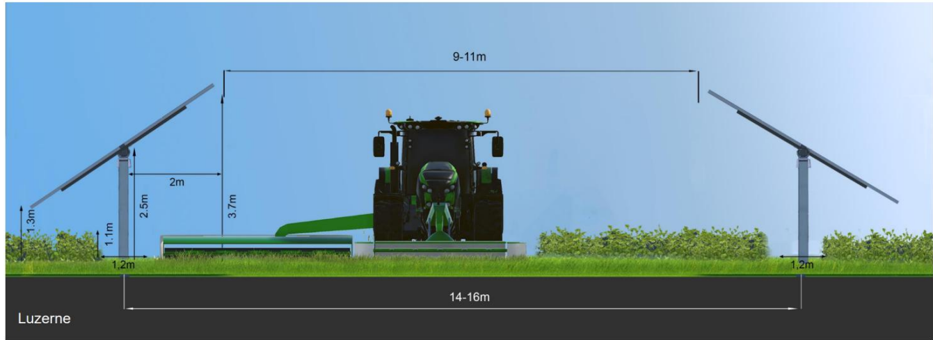
Figure 94 : Schéma de principe d'une ombrière d'élevage (TSE, 2025.)
