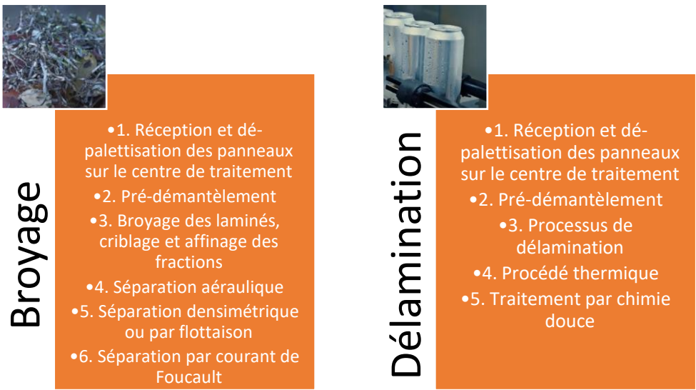
Figure 15 : Etapes du recyclage de panneaux photovoltaïques cristallins par broyage (gauche) ou par délamination (droite) (SOREN, 2025.)
