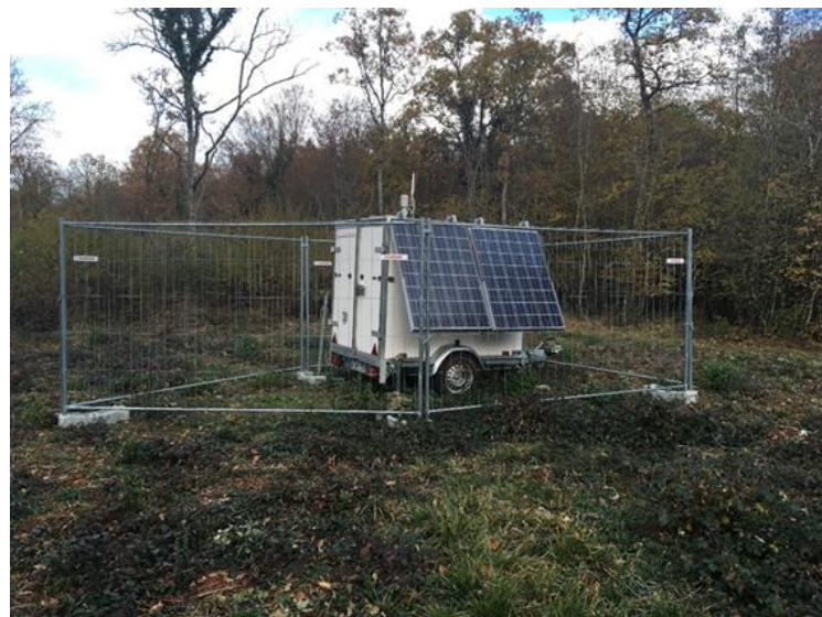
Photo 2 : Installation d'un dispositif LIDAR (Source : wpd)
