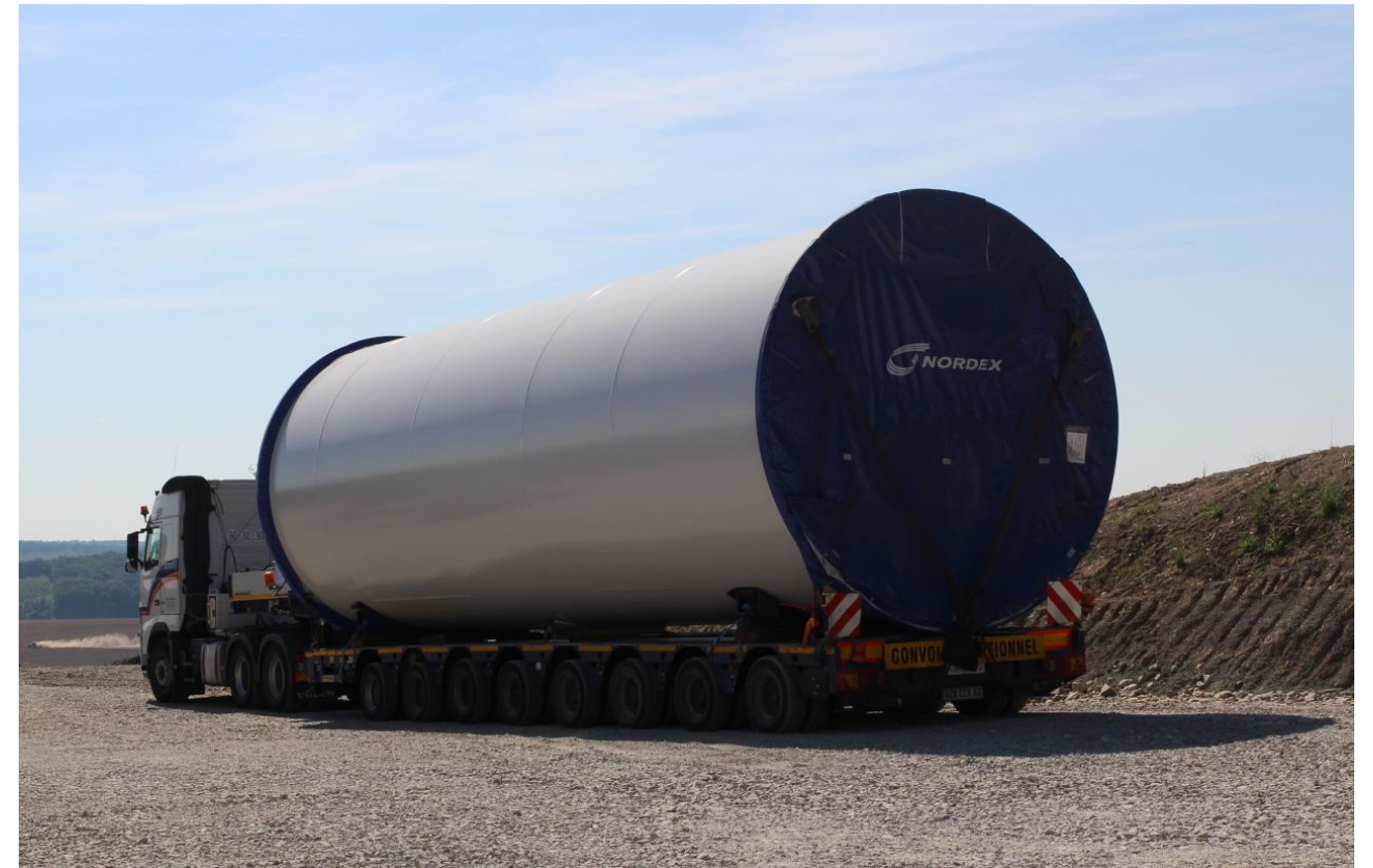
Photo 8 : Transport d'une section de mât d'éolienne (Source : Ora environnement)
