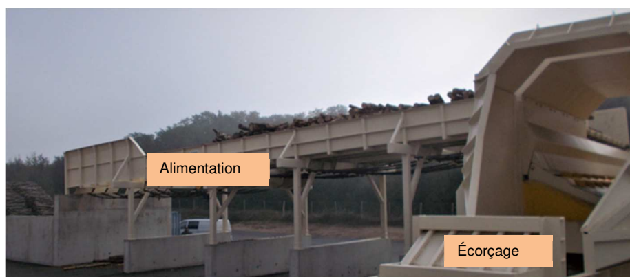
Illustration n° 6 : Exemple d'alimentation et d'écorçage des rondins
