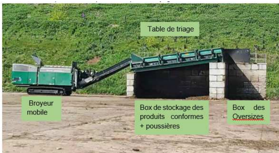
Illustration n° 8 : Exemple de configuration de broyage - criblage
