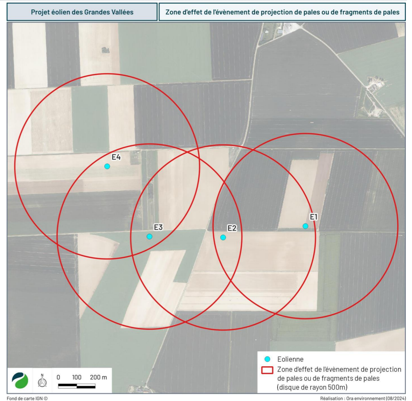
Carte 14 : Zone d'effet de l'évènement de projection de pales ou de fragments de pales
