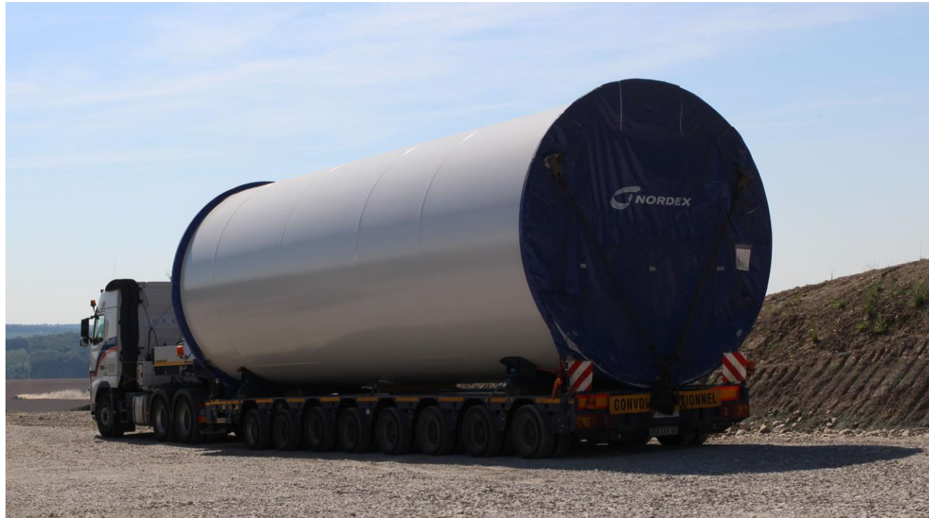
Photo 4 : Transport d'une section de mât d'éolienne (Source : Ora environnement)
