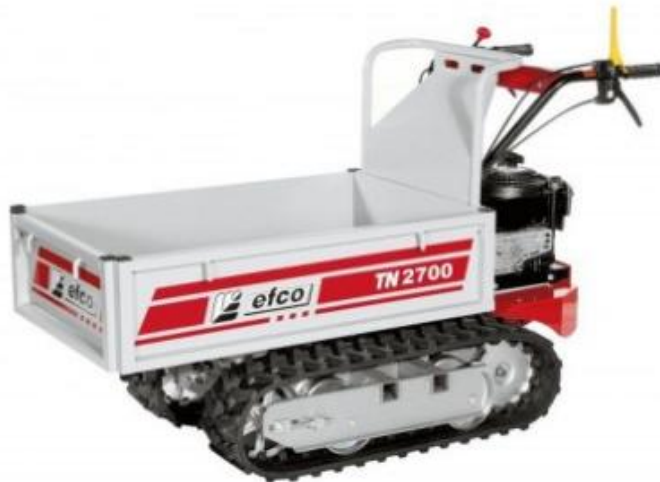
Figure 91 : Exemple de transporteur à chenille utilisé pour les interventions sur les parcs photovoltaïques
