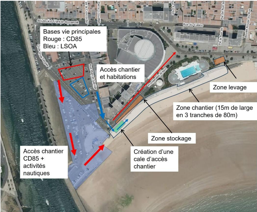
Figure 64 : Emplacements des installations de chantier
