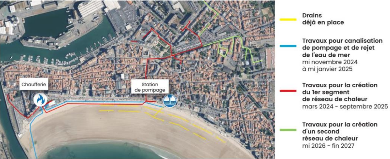
Figure 38 : Travaux liés au réseau de chaleur (réalisés ou à venir) – Source : Ecoplage
