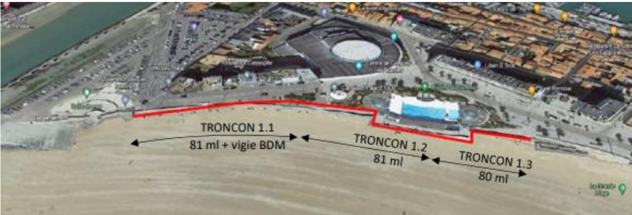
Figure 15 : Phases de réhabilitation des ouvrages de défense contre la mer
