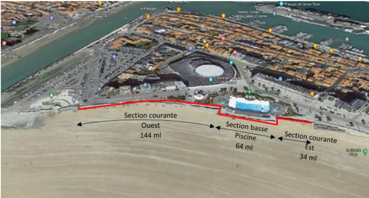
Figure 14 : Ouvrages à traiter
