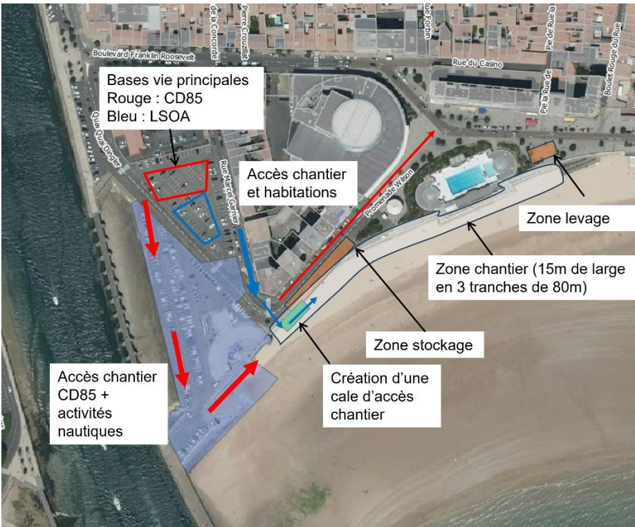
Figure 16 Emplacements des installations de chantier
