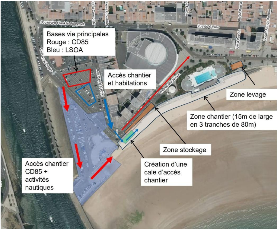
Figure 8 : Emplacements des installations de chantier
