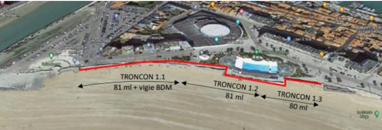
Figure 7 : Phases de réhabilitation des ouvrages de défense contre la mer
