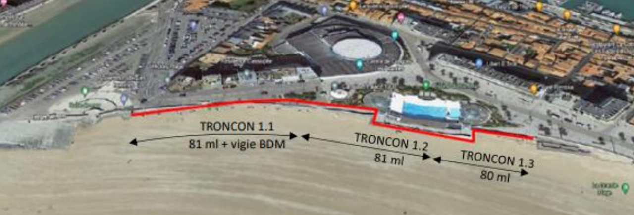
Figure 7 : Phases de réhabilitation des ouvrages de défense contre la mer
