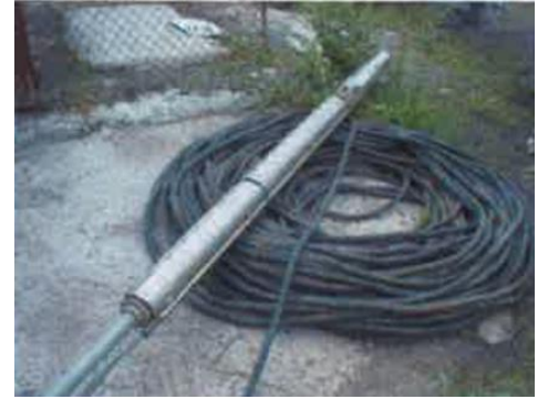
Exemple de pompe pour puits d'eau
