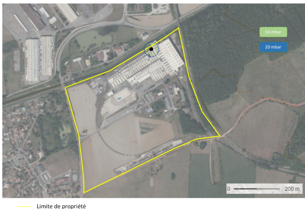
Figure 35 : Représentation graphique – effets de surpression – Rupture d'une canalisation de gaz naturel extérieure (Vue éloignée)
