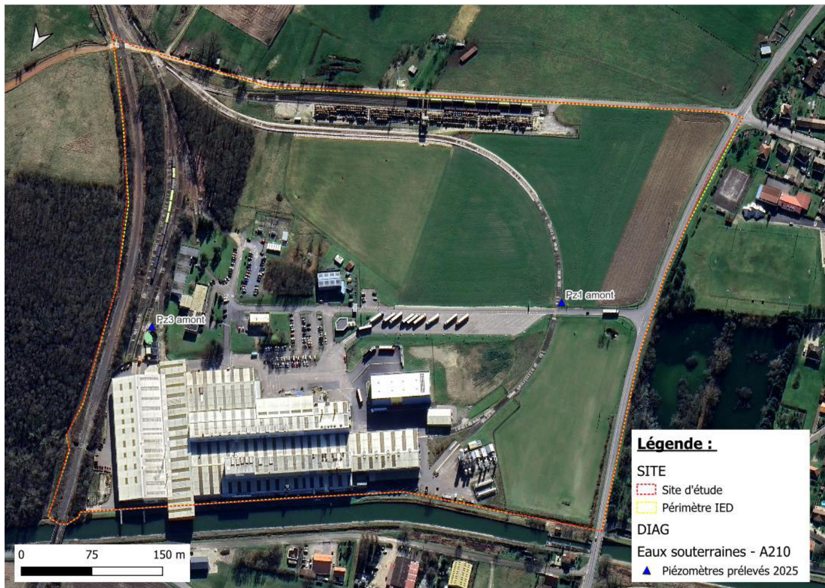
FIGURE 7 : PLAN DES INVESTIGATIONS SUR LES EAUX SOUTERRAINES
