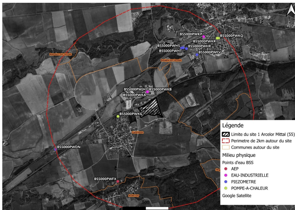
Figure 10 : Captage AEP (Banque du sous-sol)
