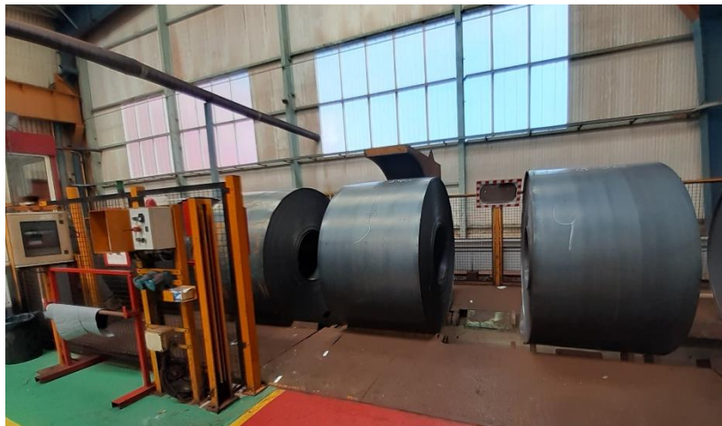
Figure 22 : Arrivée des bobines brutes sur la ligne de décapage
