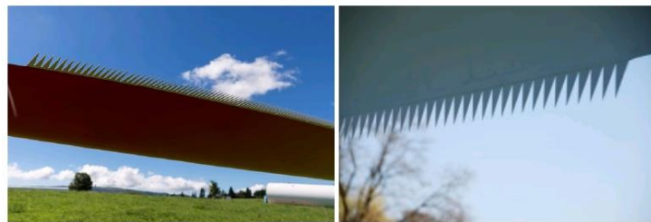
Photographies d'une pale dotée d'un système STE ou TES (peigne / dentelure)
