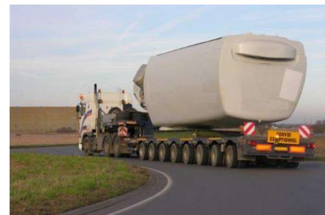
Photo 9 : transport de la nacelle
