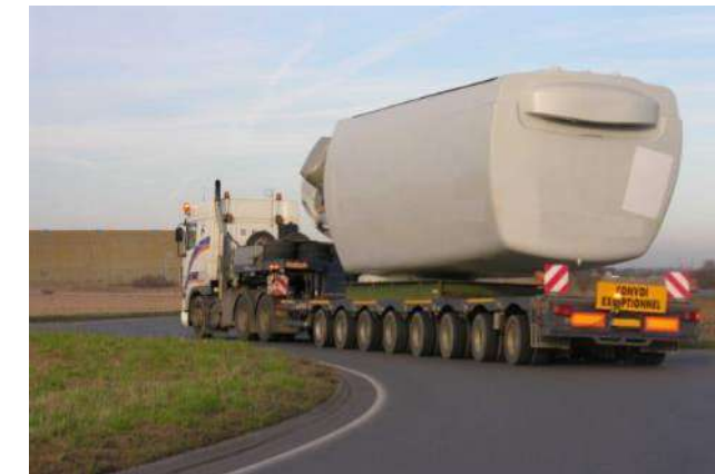
Photo 50 : transport de la nacelle
