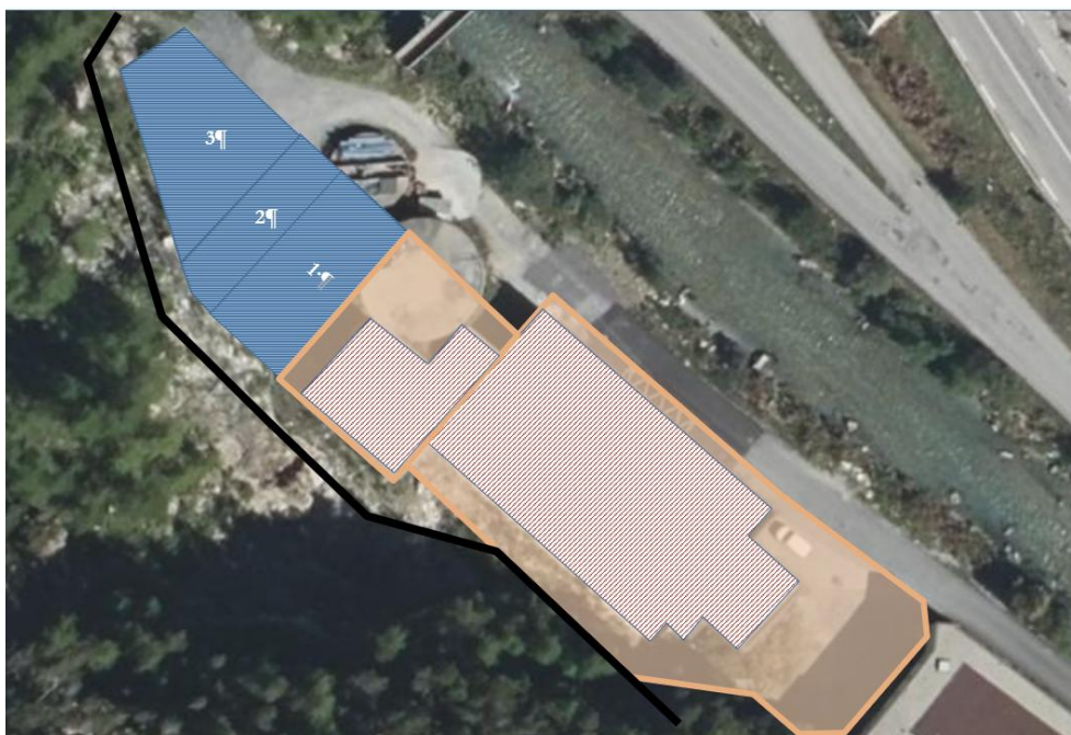
Phase 4 : Démolition du traitement physico-chimique et du bâtiment prétraitements/traitement des boues
