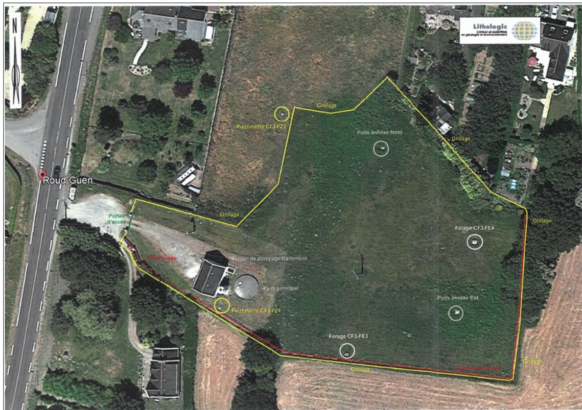
Plan de localisation des puits de captage, des nouveaux forages et des piézomètres du site de Roud Guen sur fond photo aérienne.
