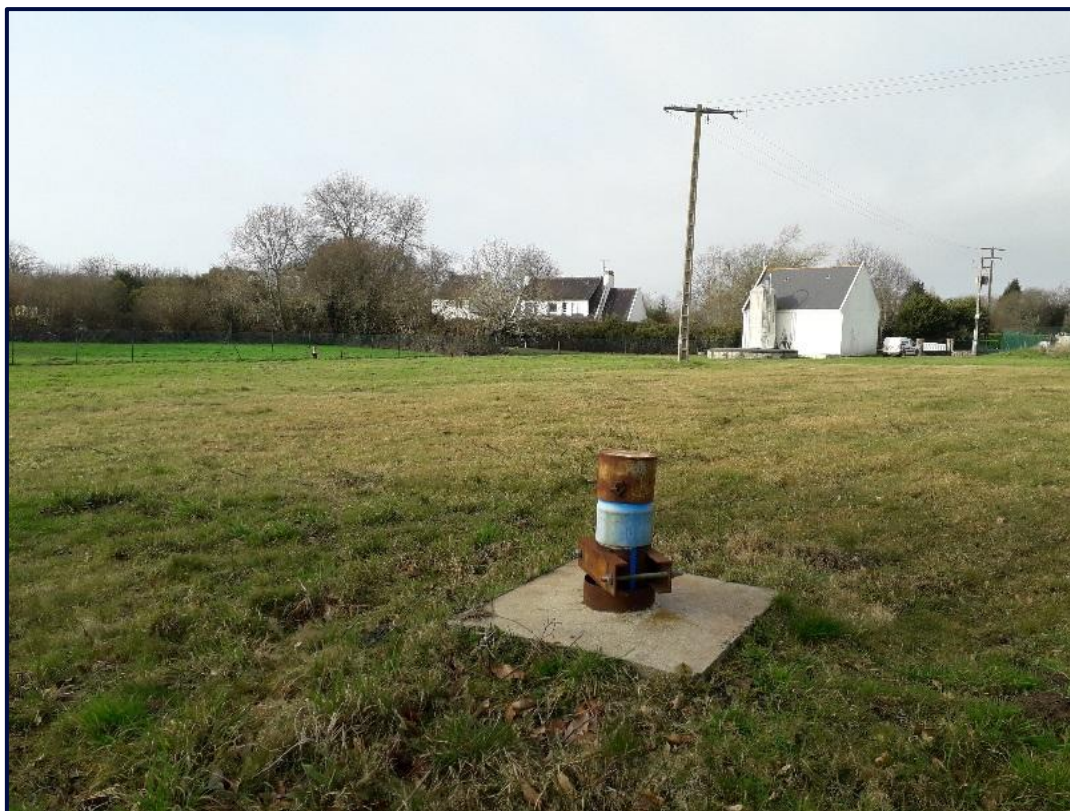
Figure 5 : Photographie du forage CF3-FE4 avec citerneau de protection
