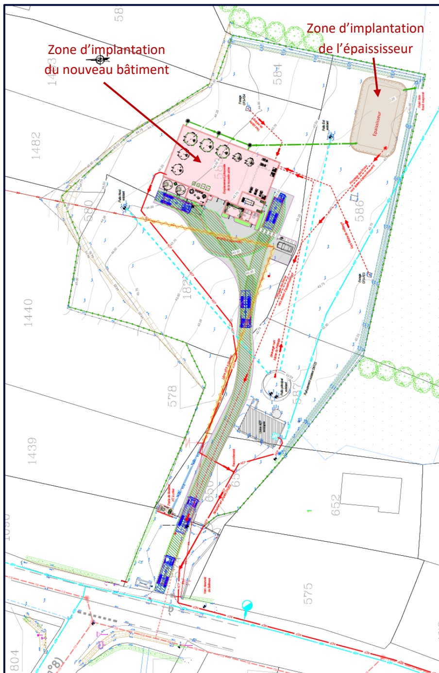
Figure 2 : Plan masse de l'usine et des forages
