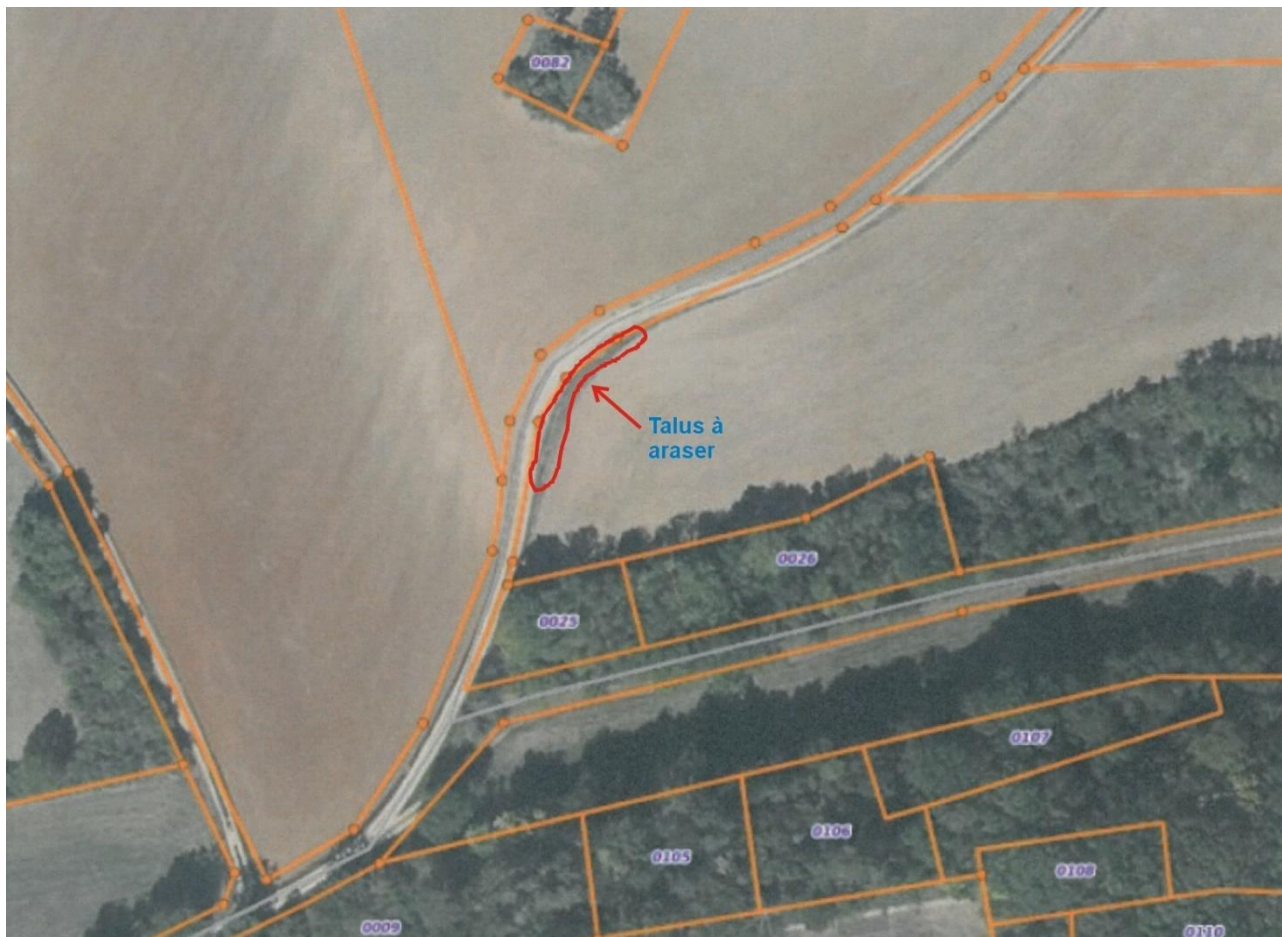
Figure 23 : Localisation du talus prévu à l'arasement
