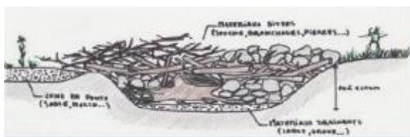
Schéma de principe d'un gîte artificiel (Source : SOGREAH)
