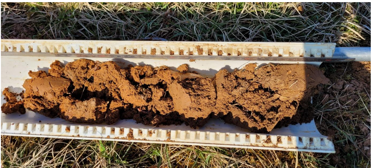
Carottage pour sondage pédologique S3 (source : Eco-Stratégie)
