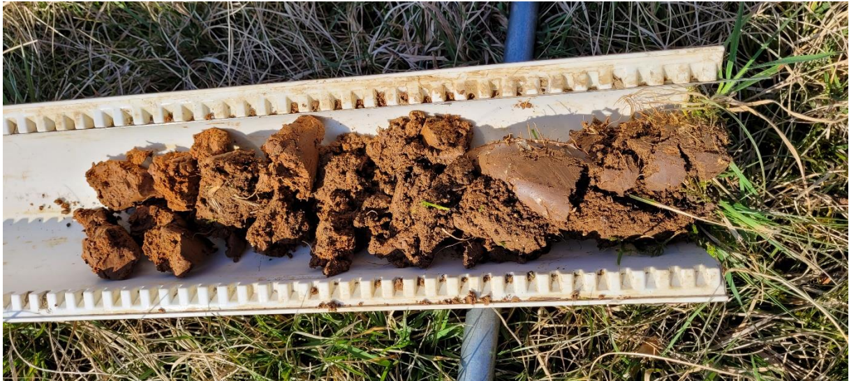
Carottage pour sondage pédologique S5 (source : Eco-Stratégie)
