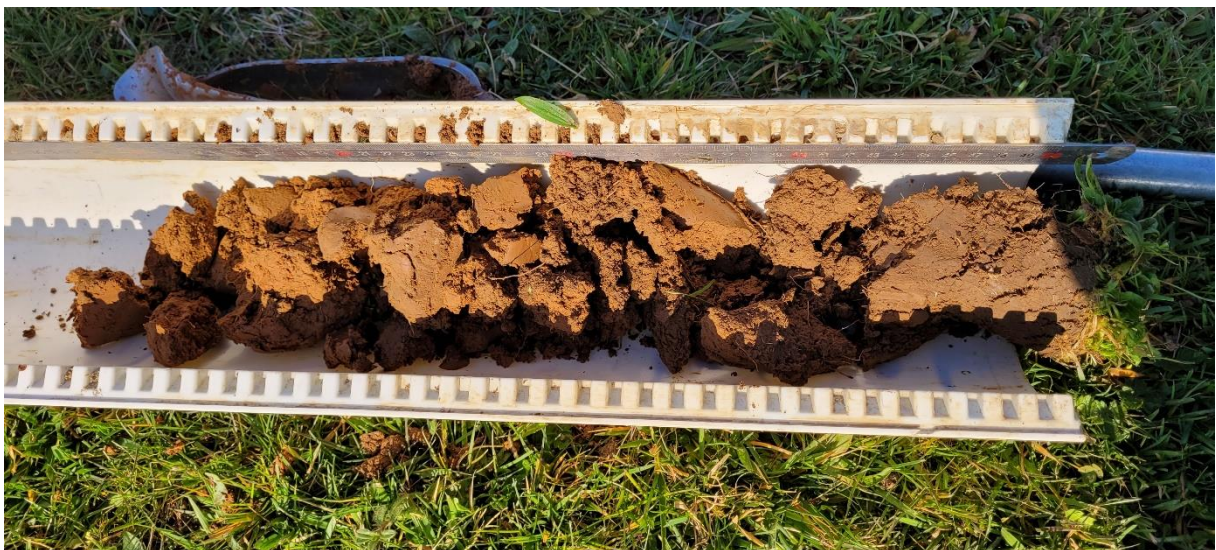
Carottage pour sondage pédologique S6 (source : Eco-Stratégie)
