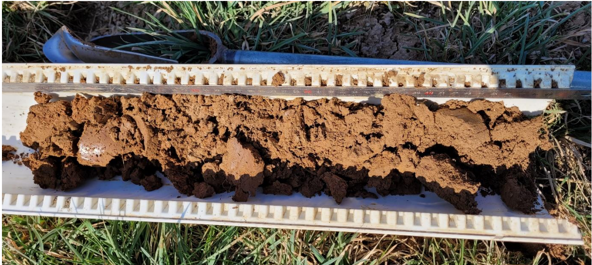
Carottage pour sondage pédologique S4 (source : Eco-Stratégie)
