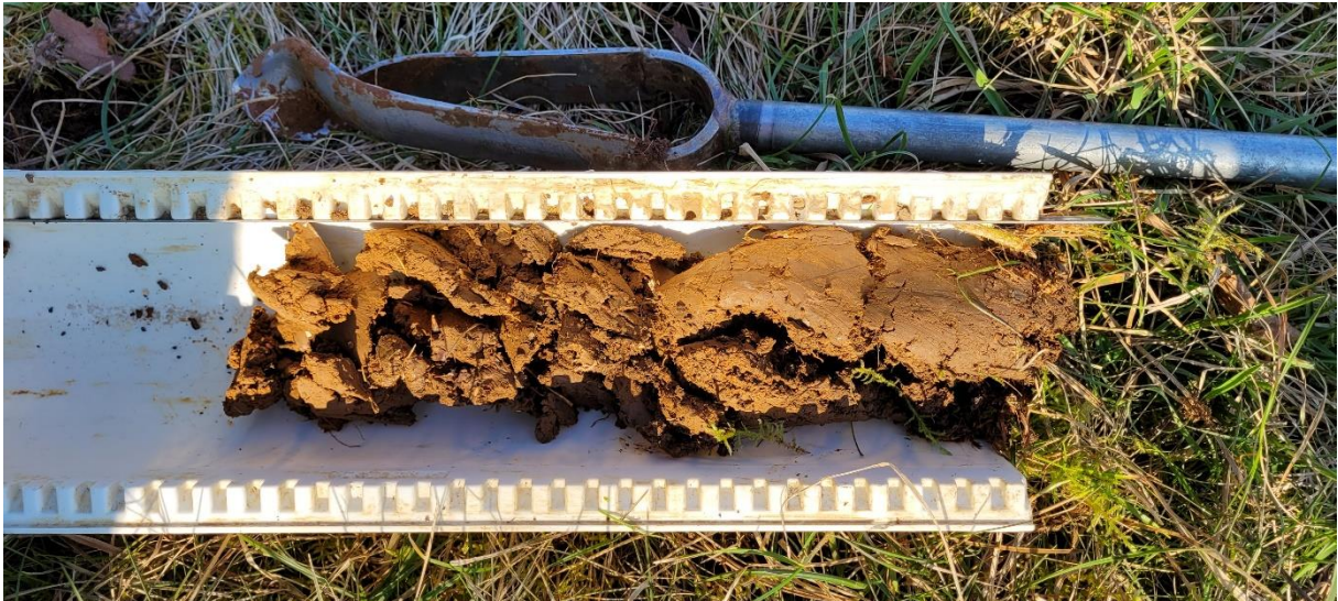
Carottage pour sondage pédologique S1 (source : Eco-Stratégie)
