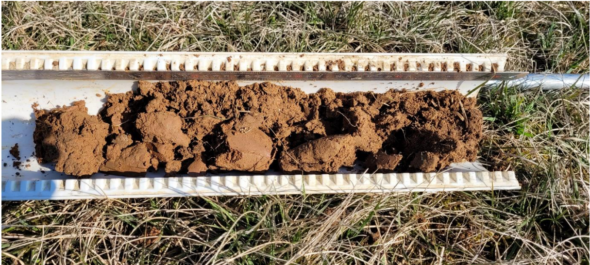
Carottage pour sondage pédologique S2 (source : Eco-Stratégie)
