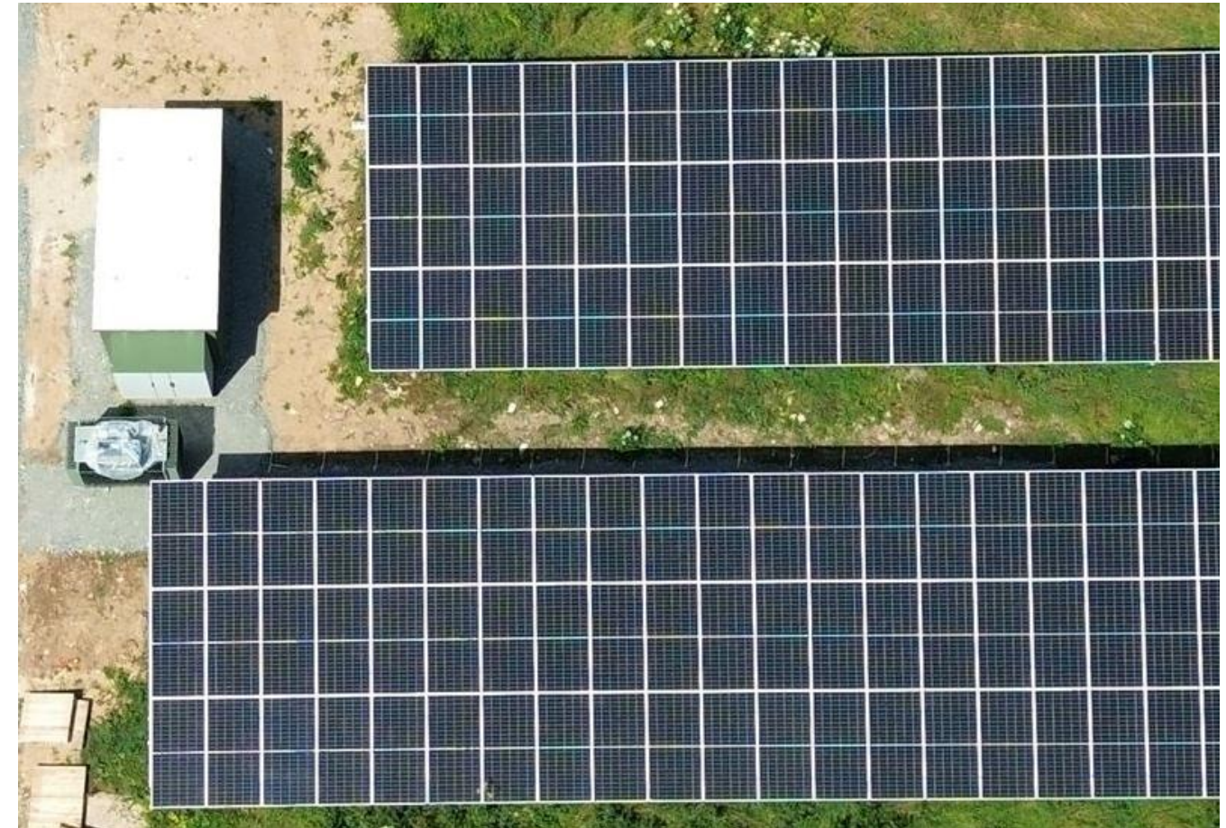
Illustration 1 : Exemple de panneaux utilisés par IEL, avec quadrillage permettant de limiter l'effet attractif envers les insectes ou les oiseaux (impression de plan d'eau en cas de surface non texturée).
