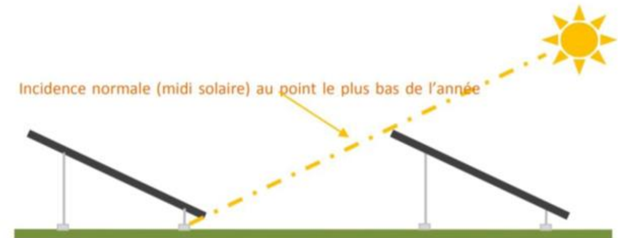
Figure 26 : Principe d'espacement des rangées en fonction du soleil
