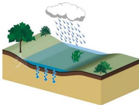
Figure - Noue engazonnée et plantée infiltrante. Source Architecture & Climat.
