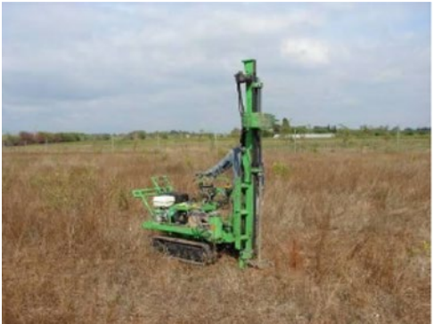
Figure 17 et Figure 18. Sondage au pénétromètre et Log type (source : Valeco)
