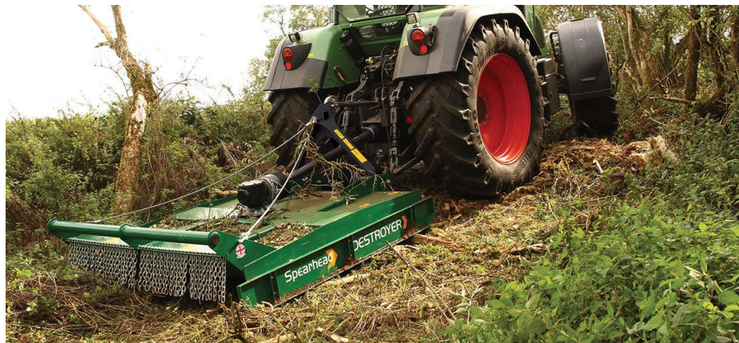
Figure 20. Débroussaillage avec le gyrobroyeur (source : Valeco)
