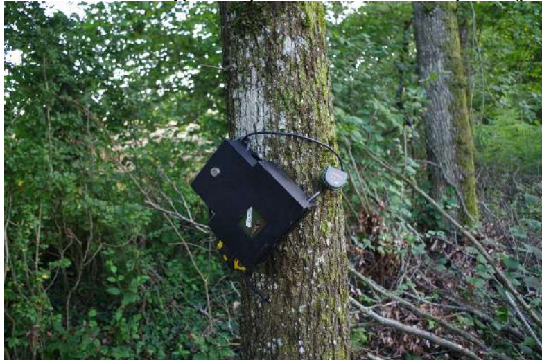
Illustration 4. Enregistreur à ultrasons de type SM4 pour inventorier les chiroptères (photo prise hors site).
