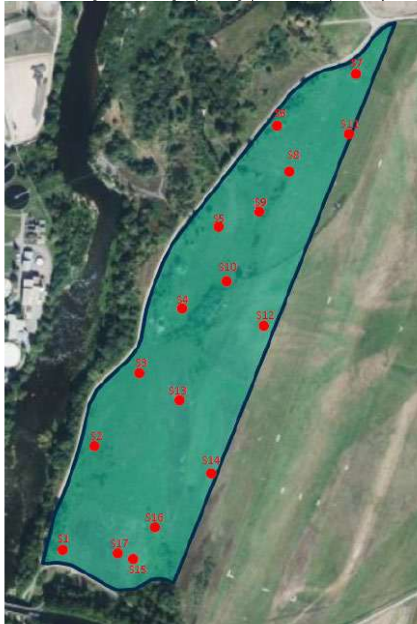
Illustration 3. Plan d'échantillonnage des sondages pédologiques réalisés par Tecnydro.
