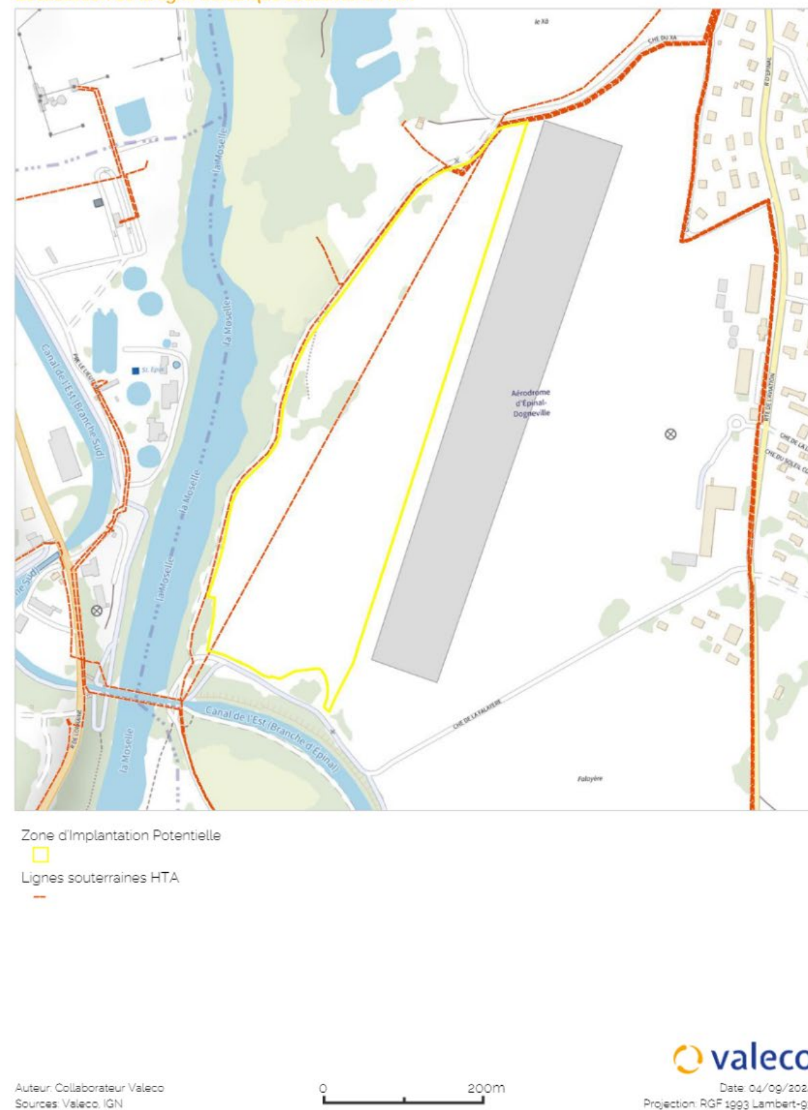
Figure 28 : Ligne HTA traversant le site
