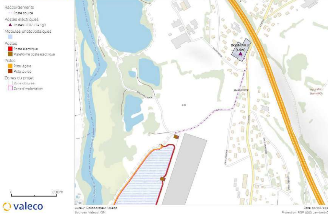
Figure 33 : Raccordement au poste source le plus proche
