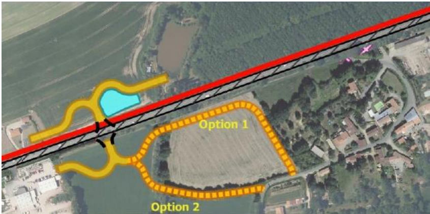
Figure 19 - Options de rétablissement de la Dédrière (extrait figure 44, pièce E – partie 4)
