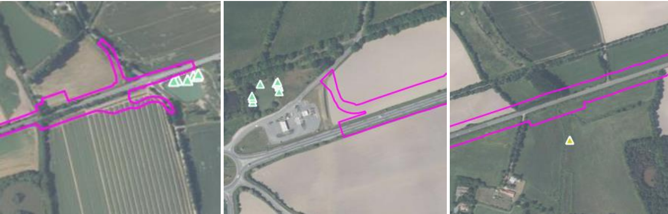
Figure 24 : Localisation des espèces protégées végétales vis-à-vis de l'emprise travaux (ligne rose) / De gauche à droite : section 1 : Cicendie naine (triangle vert) - Section 2 : Cicendie naine (triangle vert) et Cornifle submergé (triangle jaune)
