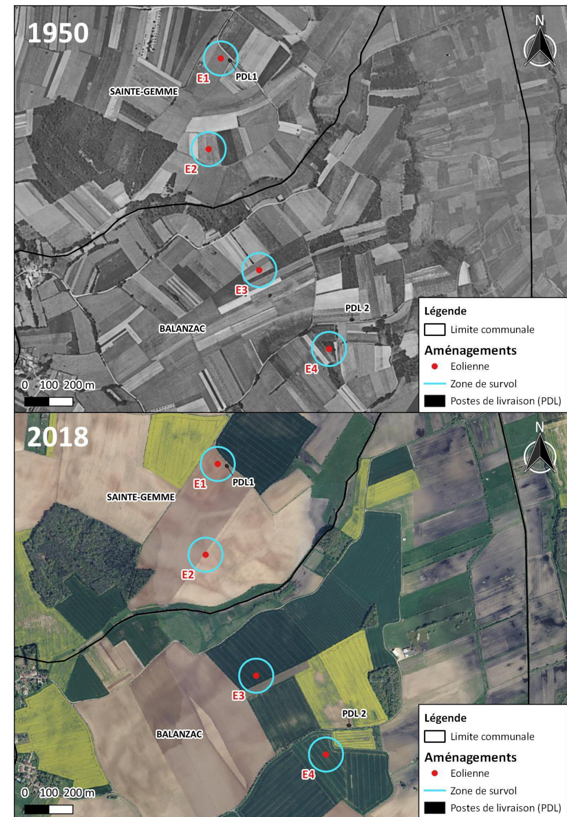
Figure 25 : Implantation de la variante retenue à 4 éoliennes
