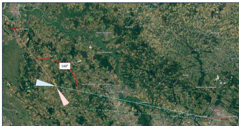
Figure 6 – Recouvrement du secteur de potentielle perte de détection entre capteurs militaires interconnectés (Référence Google Earth)
