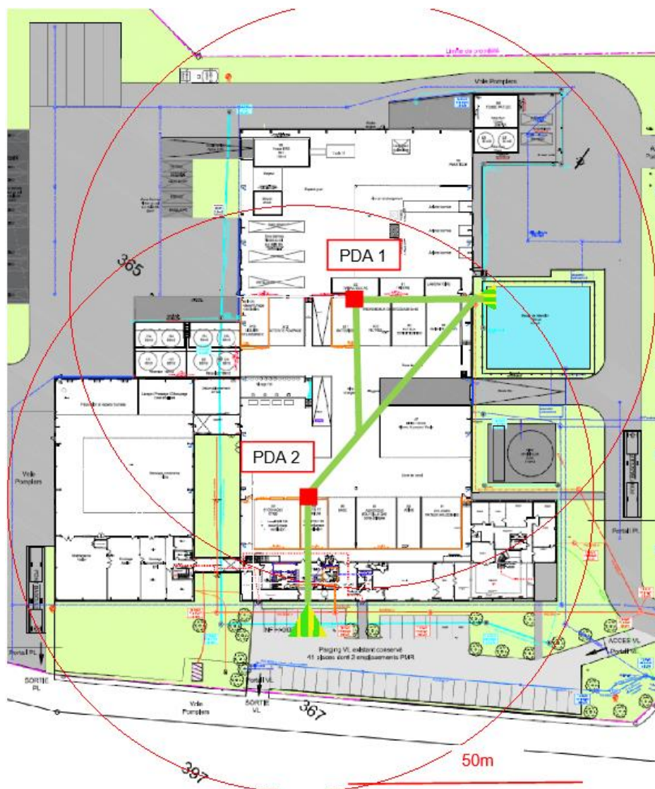
Figure 9 : Implantation des paratonnerres
