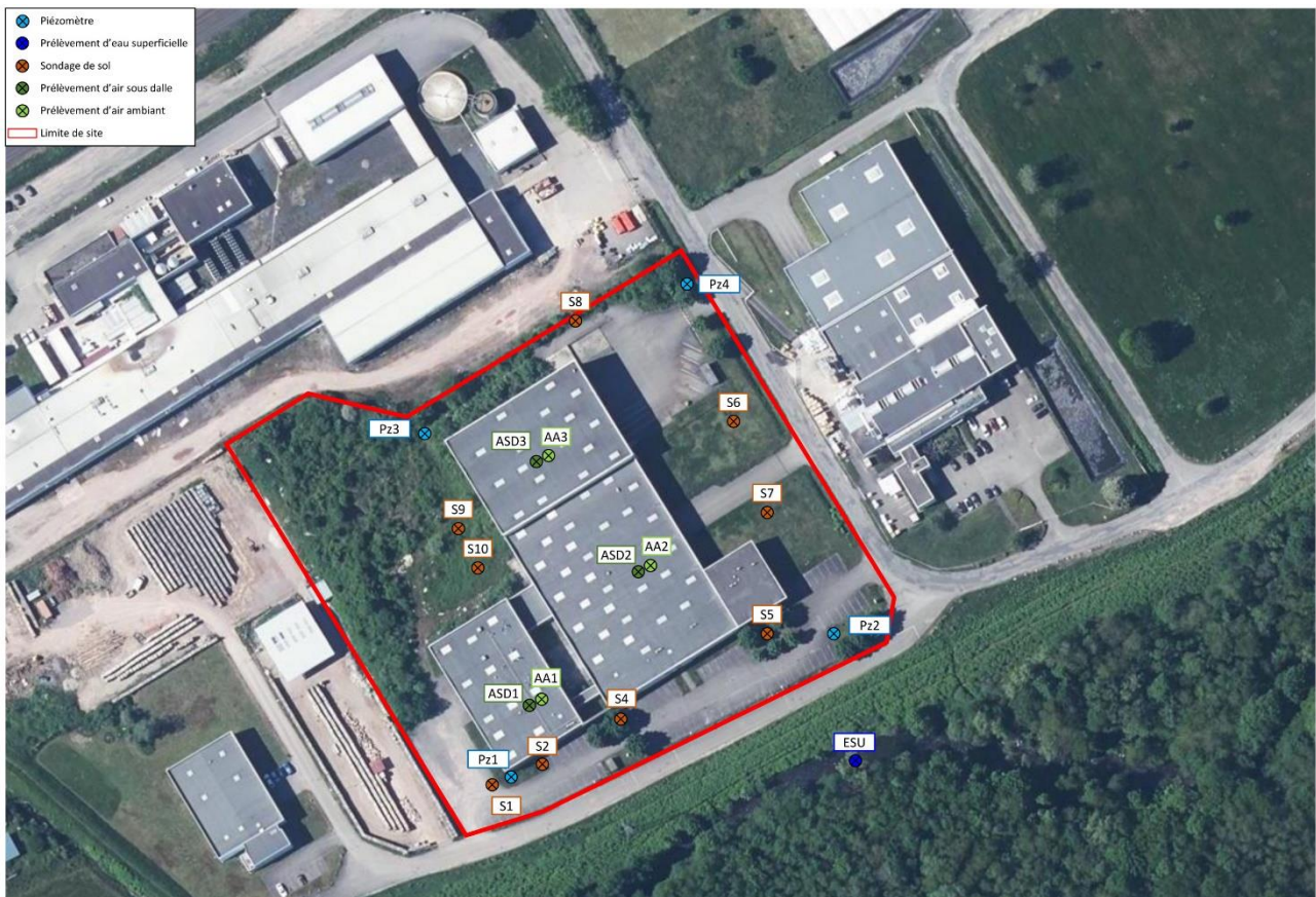
Figure 12 : Localisation des sondages de sols et des piézomètres (extrait du rapport ABO ERG Environnement – n°51288)
