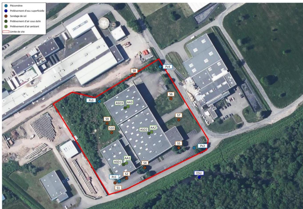
Figure 10 : Localisation des sondages de sols et des piézomètres (extrait du rapport ABO ERG Environnement – n°51288)
